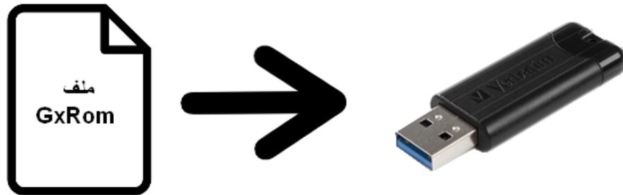
3) Eteignez le récepteur par le câble d'alimentation électrique, ensuite, insérez la clé usb dans le port usb du récepteur, Rallumez-le, puis appuyez deux ou trois fois sur le bouton marche/arrêt si vous utilisez la télécommande, si vous utilisez le bouton marche/arrêt du récepteur, il suffit d'appuyer une seule fois pendant quelques secondes jusqu'à ce que le mot "Upgrade" s'affiche sur l'afficheur, puis relâchez le bouton. Attendez que le processus se
